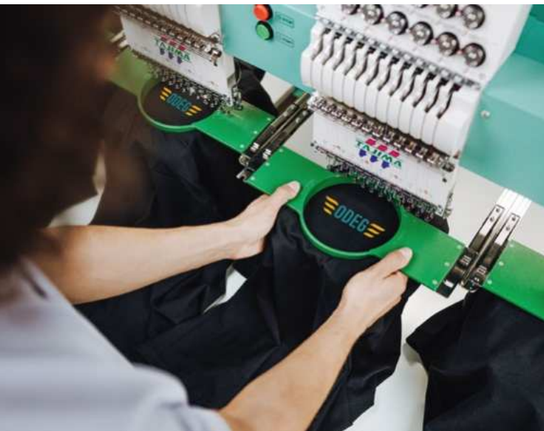
Stickmaschine beim Besticken des ODEG-Logos
