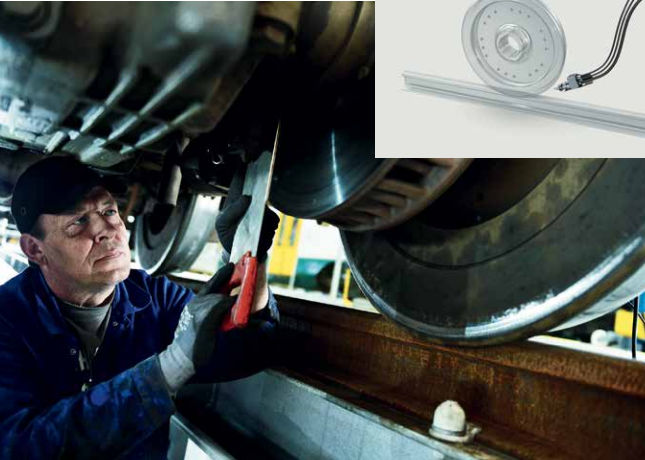
Bild oben: Das Sandungs- system unterstützt die sichere Zugbremsung. Bild unten: Bremsen-Produktion von Knorr-Bremse in Berlin
